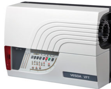
Die im ganzen Raum ausgelegten Rohre laufen im Detektor zusammen (Eingänge rechts), hier wird die angesaugte Luft auf Rauchpartikel geprüft.
